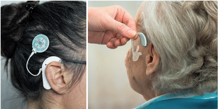
Zum Vergleich: links Cochlea Implantat Prozessor, rechts Hörgerät (HdO)
